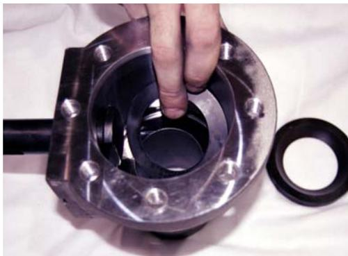
21) Insérer la rondelle dans le corps de façon à ce que son plus grand diamètre repose au fond du corps.
