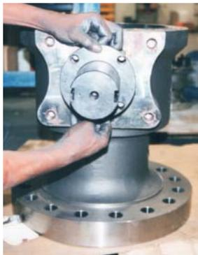
**NOTE:** Le marquage position fermée du fouloir doit se situer à l'horizontale sur le coté gauche de l'axe.
