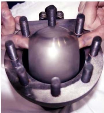
20) Retirer le siège intégral, la boule et le siège amont.
