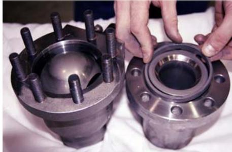
29) Réinstaller la rondelle Belleville, le siège amont et la boule (côté ayant subi un rodage de précision face à l'ouverture).
