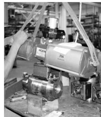
9. ValvTechnologiesが提供するオペレータアダプタープレートは全て、プレートの中央に機械で穴が開けられています。このプレートをバルブに取り付ける場合、取付板がバルブを支えるように、ボルトを締める前にシャフトと同心になるようにして下さい。ボルトを締める前に、同心性を再度必ず確認して下さい。バルブに対してオペレータをずれた位置に設置してしまうと、オペレータを綴じ込んでしまう原因となり、それにより、バルブまたはオペレータが損傷してしまう場合があります。
