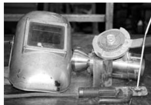
アクチュエーターへの熱損傷が不安である場合、放射シールドの使用をお勧めします。バルブ内への溶接スラグや飛び散りを最小限に抑える工夫をして下さい。アークをバルブに当てないようにして下さい。
