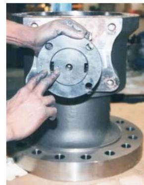
3) A haste deve ser orientada de forma que as superfícies planas da lingüeta fiquem paralelas à passagem.
