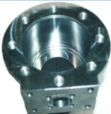
1) O corpo é posicionado em seu flange de admissão, cubo preso ou extremidade soldada com a cavidade do corpo voltada para cima.
