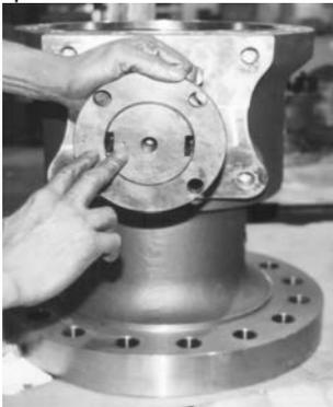
3. La tige doit être orientée de telle sorte que les parties plates soient parallèles à l'alésage.
