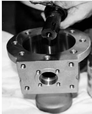
2. La tige est insérée à travers le trou désigné sur le côté de la cavité du corps.
