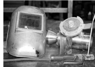
L'utilisation de protections anti-radiations est conseillée si les dommages de l'actionneur liés à la chaleur sont un problème potentiel. Une attention particulière doit être portée pour minimiser les scories et éclaboussures de soudure dans la vanne. Ne pas frapper d'arcs sur la vanne.
