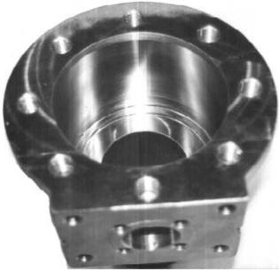
1. Le corps est placé sur sa bride d'entrée, par serrage ou soudure du moyeu d'extrémité, sa cavité tournée vers le haut.
