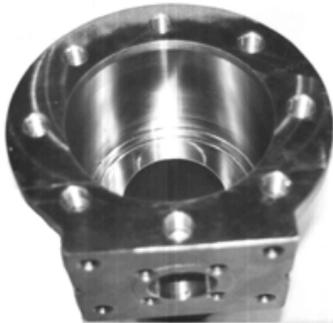
1) Gehäuse auf den Einlassflansch, Klemmanschluss bzw. Schweißanschluss stellen, so dass das Innere nach oben gerichtet ist.
