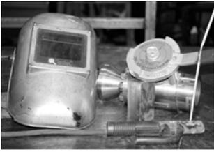
Wenn eine Beschädigung des Antriebs durch Hitze zu befürchten ist, sollte eine Abschirmung verwendet werden.
