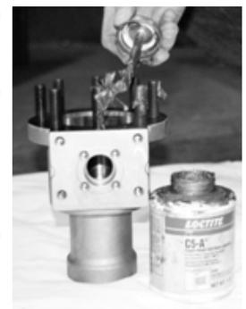
4) Schaltwellenpackung und Stopfbuchse wieder einbauen.
