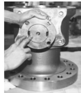
3) Die Schaltwelle so ausrichten, dass die Aussparungen für die Mitnehmerfedern parallel zur Bohrung liegen.
