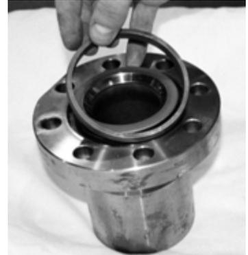
6) Gehäusedichtung/Dichtring je nach Hahnkonstruktion ausbauen.
