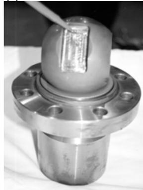
8) Kugelorientierung markieren und Kugel ausbauen; dabei vor Beschädigung schützen.
