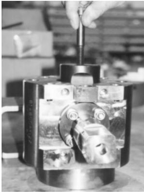
6) Mit Hilfe eines Schaltwellenhebers die Schaltwelle gegen das Gehäuse drücken.
