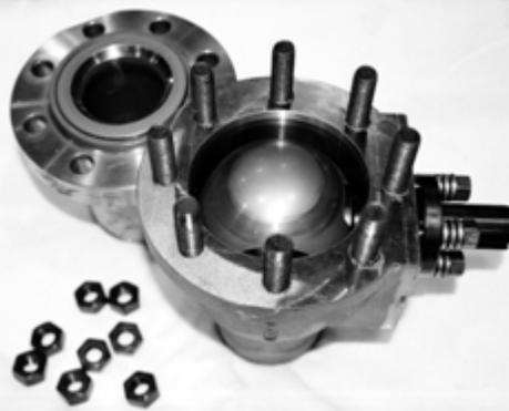
5) Die Gehäusemuttern entfernen. Gehäuse und Endkappe trennen.
