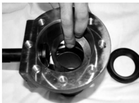
21) Tellerfeder so einsetzen, dass das größere Ende in der Vertiefung im Gehäuse ruht.
