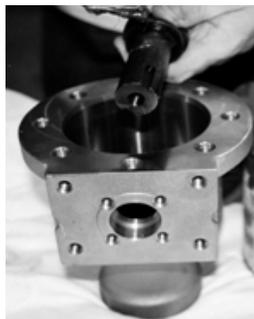
2) Schaltwelle vom Gehäuseinneren her in die Schaltwellenbohrung einführen.
