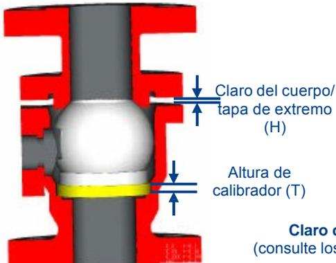
**NOTA: Si esta medición no se puede tomar directamente debido a la falta de acceso, utilice el método alternativo que se muestra a la izquierda.**
