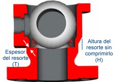
Claro de bloqueo para válvulas con orificios de 5/8", 1-1/16" y 2-1/8"
