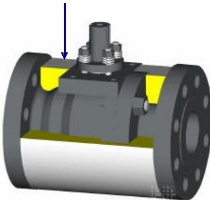
Se recomienda el aislamiento de servicio de las válvulas para aquellas que se espera soporten diferenciales de temperatura mayores que 400 °F (205 °C).
