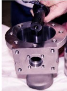
2) Se debe insertar el vástago por el orificio para el vástago desde el lado de la cavidad del cuerpo.
