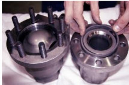
29) Reemplace el resorte Belleville, el asiento de entrada de flujo y la bola. Cerciórese de que el lado rectificado pareado quede hacia la tapa de extremo en el cuerpo de la válvula.
