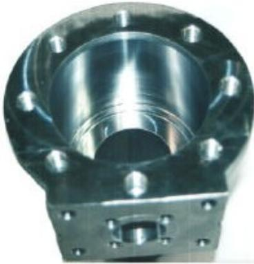
1) El cuerpo se coloca sobre su brida de entrada, el cubo sujetado o el extremo soldado con la cavidad del cuerpo hacia arriba.
